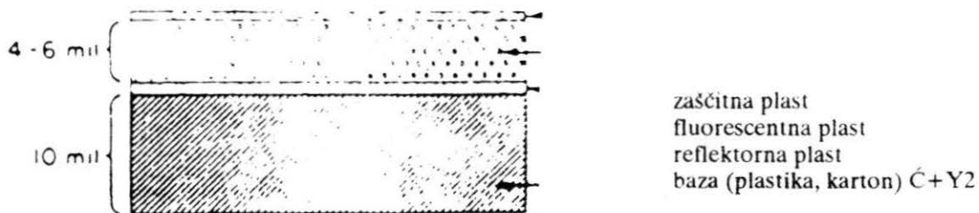
Sl. 1. Prečni presek skozi ojačevalno folijo (1 mil = 0,0254 mm)
