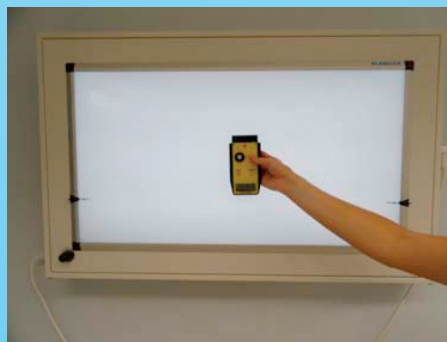
Slika 2: Primer merjenja svetilnosti negatoskopa.
