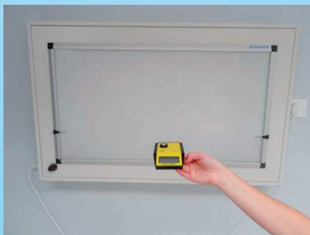
Slika 3: Primer merjenja osvetljenosti prostora na razdalji 30 cm od površine negatospoka.
