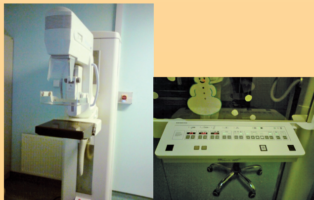
Slika 1: Digitalni mamografski rentgenski aparat (Siemens Novation DR) na Onkološkem inštitutu, uporabljen v programu DORA (levo) in stikalna plošča aparata (desno)
