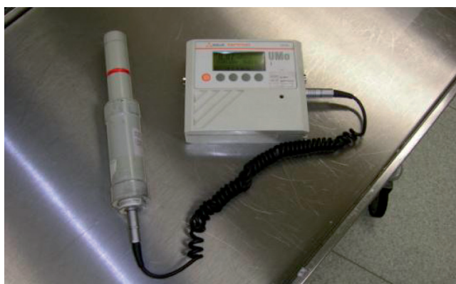
Slika 1: Dozimeter EGG Berthold LB 123 s sondo LB 1236 2230 (Gajšek, 2011)
