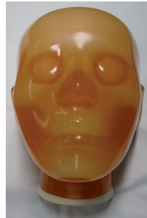
Slika 1: Fantom glave in vratu, ki je bil uporabljen v raziskavi
