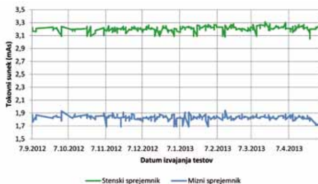
Slika 7: Delovanje AEC med izvajanjem testov
