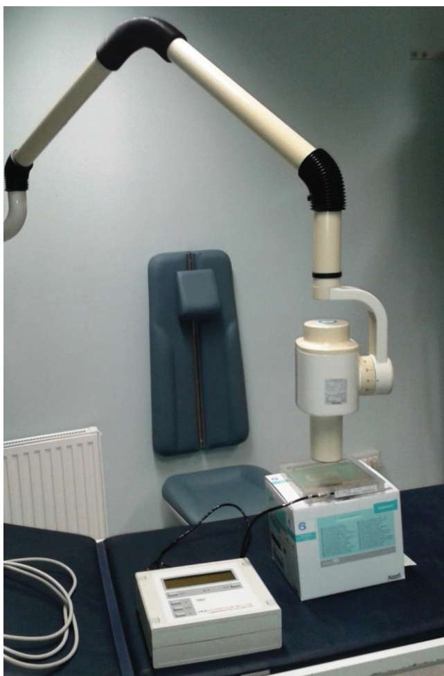
Slika 1: DAP meter ter rentgenski aparat, na katerem smo izvajali meritve
