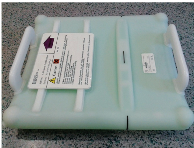
Slika 5: Fantom za izvajanje meritev RSŠ pri tuljavi za slikanje hrbtenice
