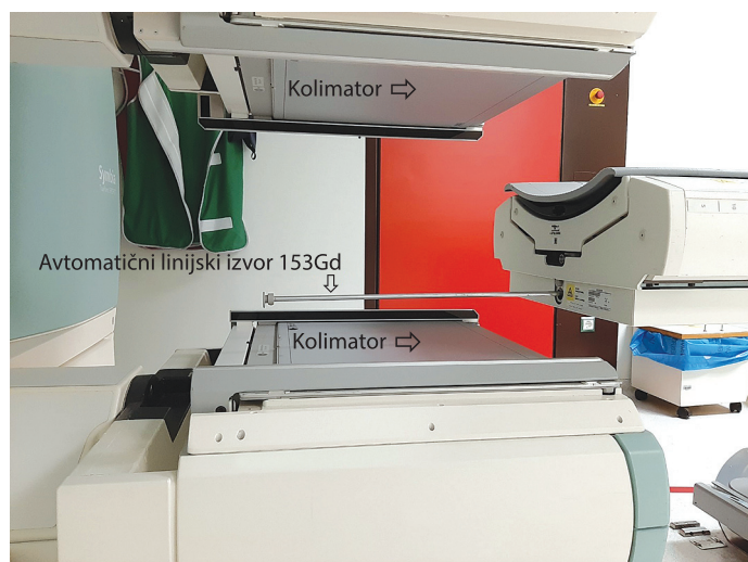
Slika 1: Sistemski test enakomernosti z avtomatičnim linijskim izvorom 153Gd
